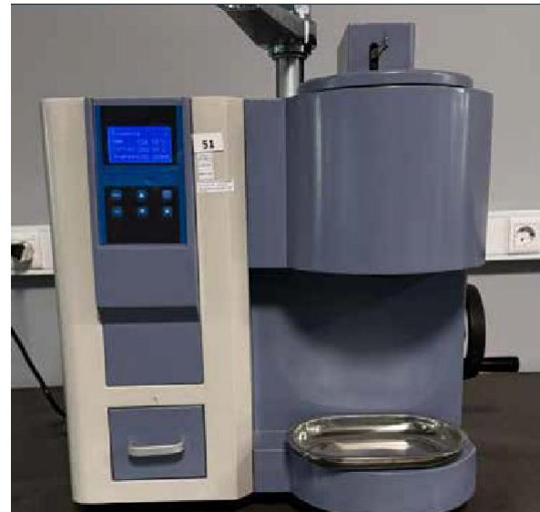
Eriyik Akış İndeksi (MFI) Ölçümü
